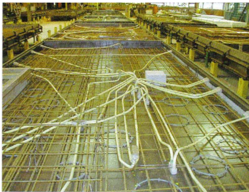
Fig. 5.4. Kant & Klaar vloer tijdens fabricage; Ref. [26].
