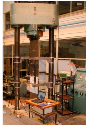
Fig. 4.15. Testopstelling druktesten; Ref. [19].
