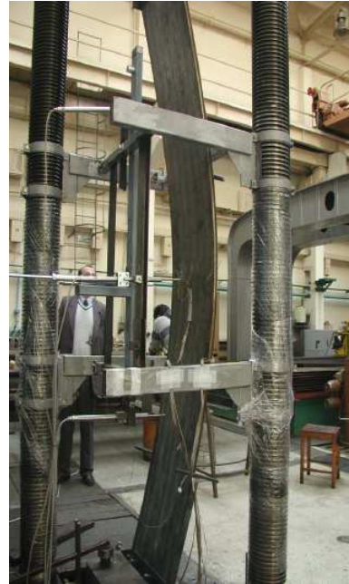
Fig. 4.18. Globaal bezwijkmechanisme; Ref. [19].
