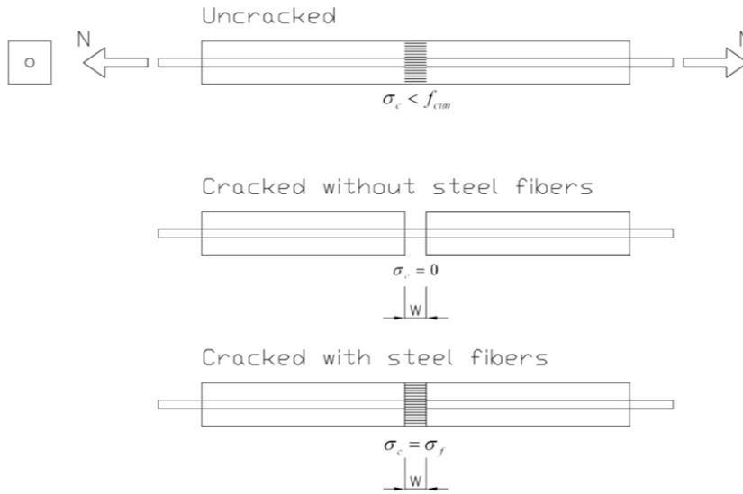
Fig. 5-1 Axial tensile bar
