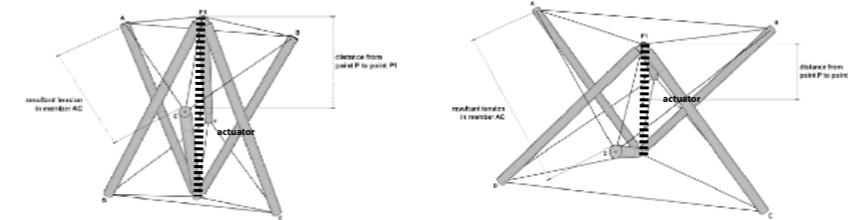
Image 2.69. A by-pyramid simplex (image courtesy of d'Estrée Sterk 2003).
